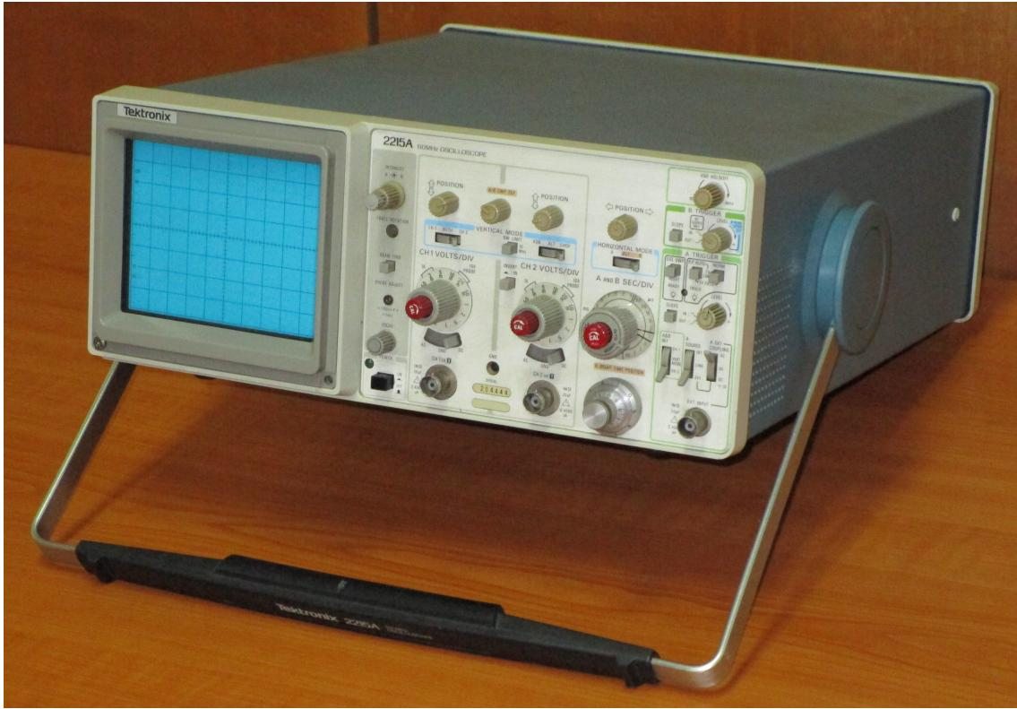
Slika 1.1: Analogni osciloskop Tektronix 2215A.
