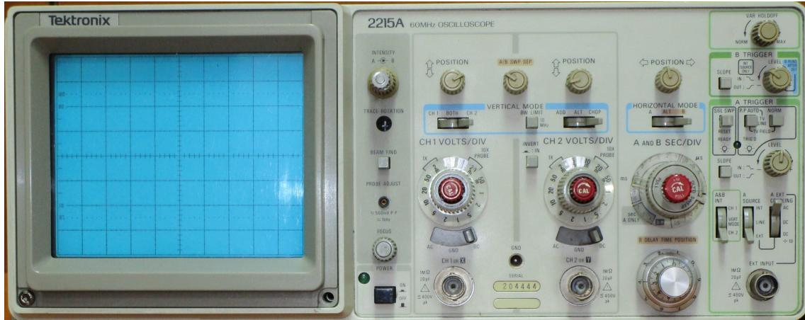
Slika 2.4: Prednja ploča osciloskopa Tektronix 2215A.
